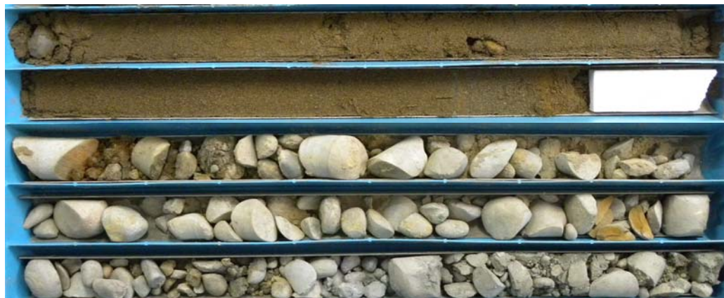
圖 3 沖積扇相礫石，可見沖積扇礫石與上覆松山層砂銳利接觸（二重 1 號井，深度 106~111 公尺）。
