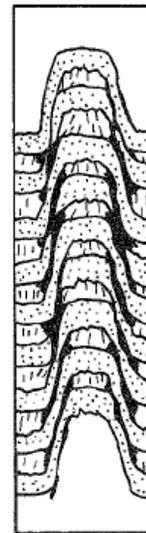
圖 9.5 微褶皺作用發育出來的劈理之形成過程。A：強岩層厚度小於弱岩層厚度之情形；B：強岩層厚度大於弱岩層厚度之情形。（摘自 Price and Cosgrove, 1991）
