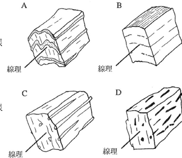
圖 10.1 線理的基本型態。A：交面線理；B：皺紋線理；C：拉伸線理；D：礦物生長線理。
