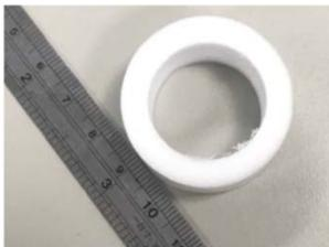
圖 5、經由岩芯研磨機可控制內外徑大小以生成圓環試體
