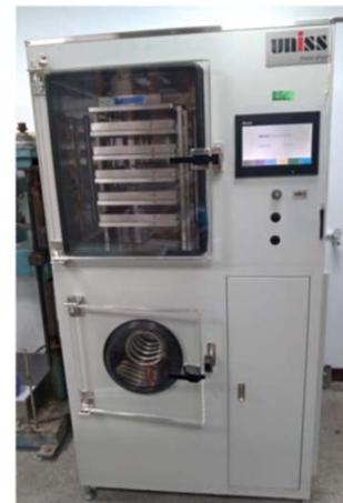
圖 9、冷凍乾燥機#
