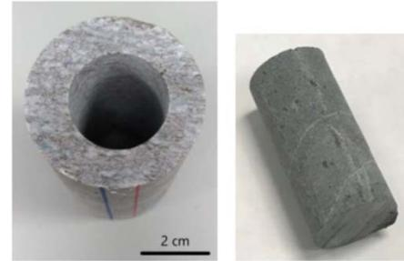
圖 7、透過岩芯鑽取機可自既有塊體中鑽取所需柱狀試體
